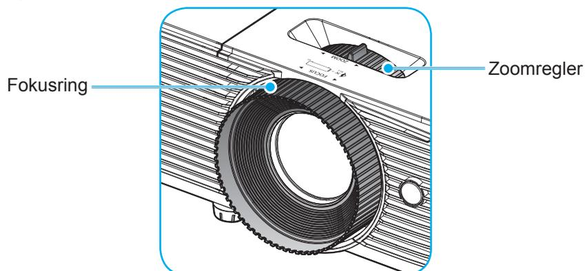
**Hinweis:** Der Projektor fokussiert auf eine Entfernung von 1 bis 12 m (SVGA-, XGA- und WXGA-Modelle).
